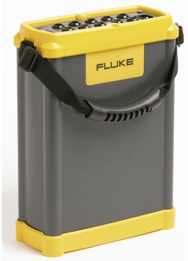
Рисунок 2.4.1 Регистратор параметров электроэнергии Fluke-1750
