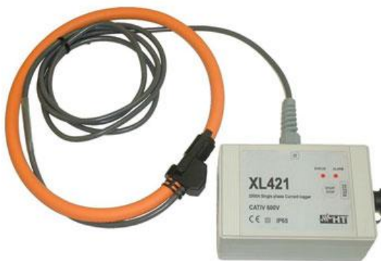
Рисунок 2.5.1 XL421 - регистратор тока (однофазный)
