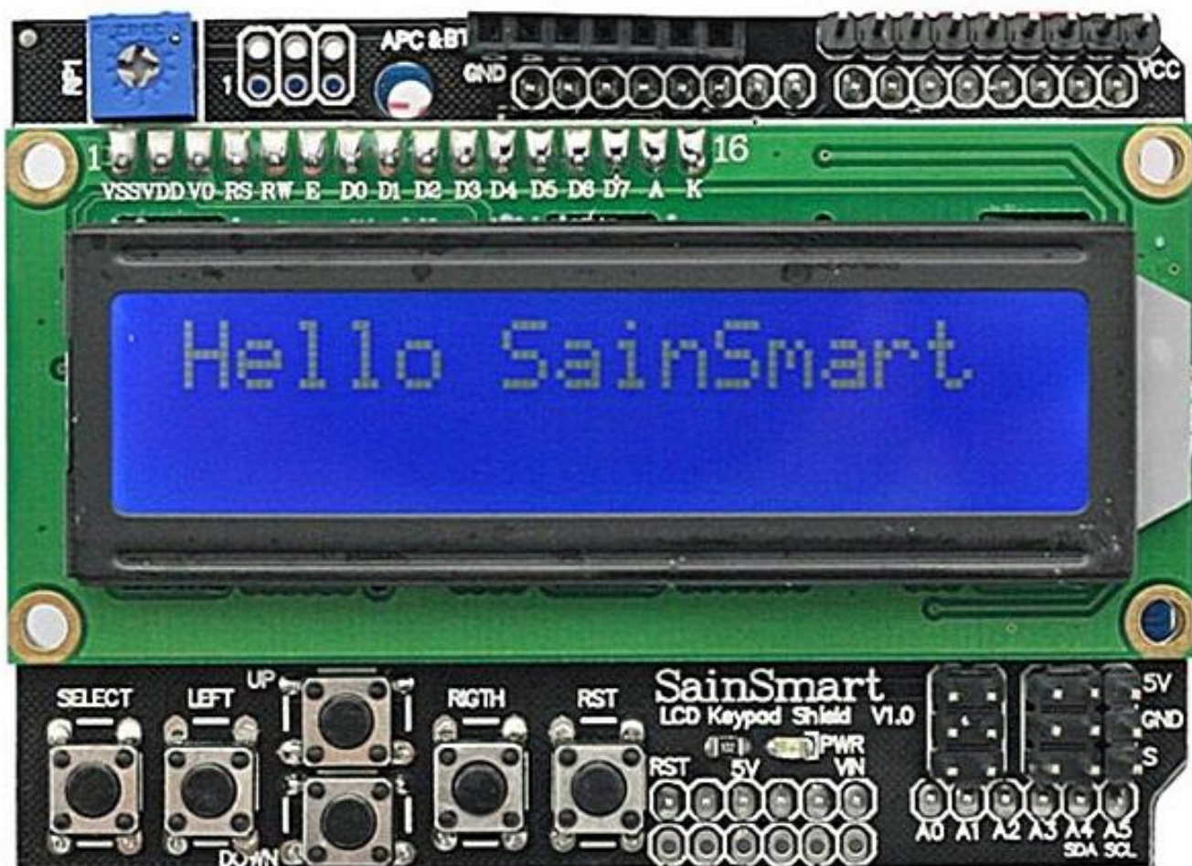
Рисунок 4.2- Шилд LCD keypad 1602 d1
