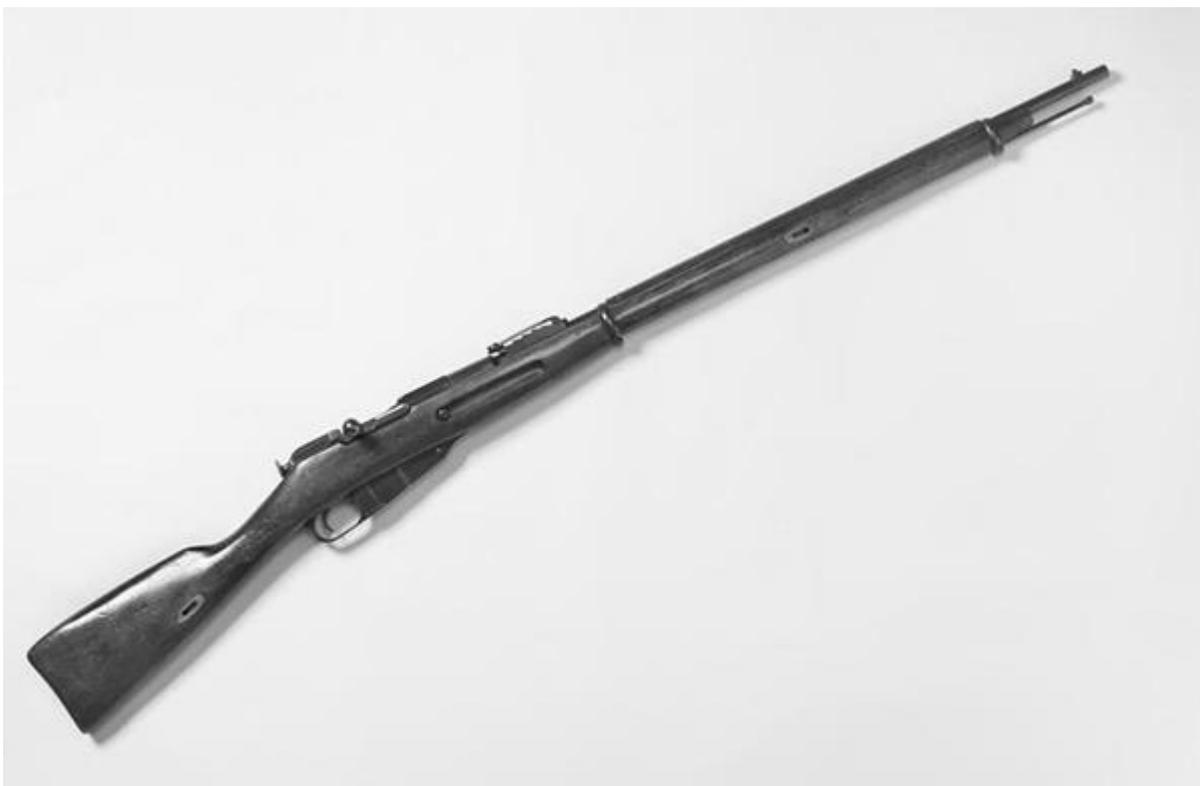
7,62-мм (3-линейная) винтовка образца 1891 года – магазинная винтовка, принятая на вооружение Русской Императорской армии России в 1891.
