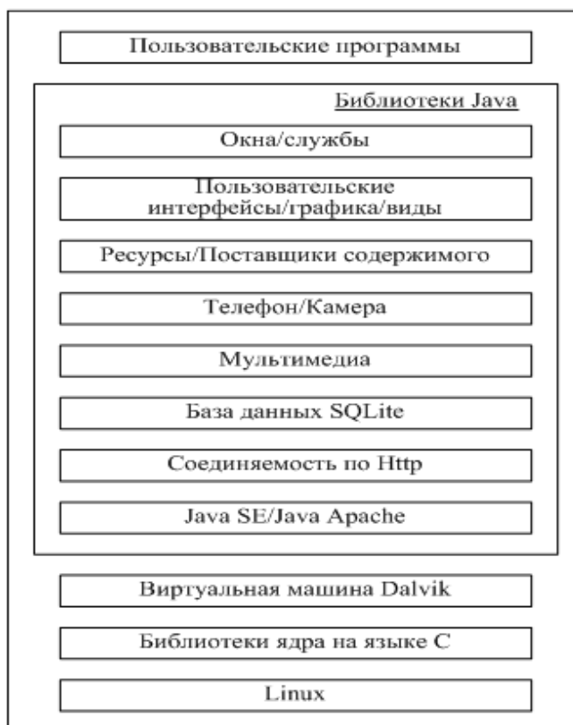
Рисунок 2.1 – Схематичное представление программного стека Android
