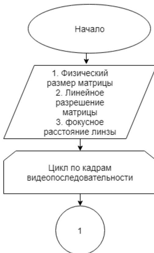
Рисунок 2.1 – Первая часть блок-схемы обобщенного алгоритма измерения роста человека по видеопотоку
