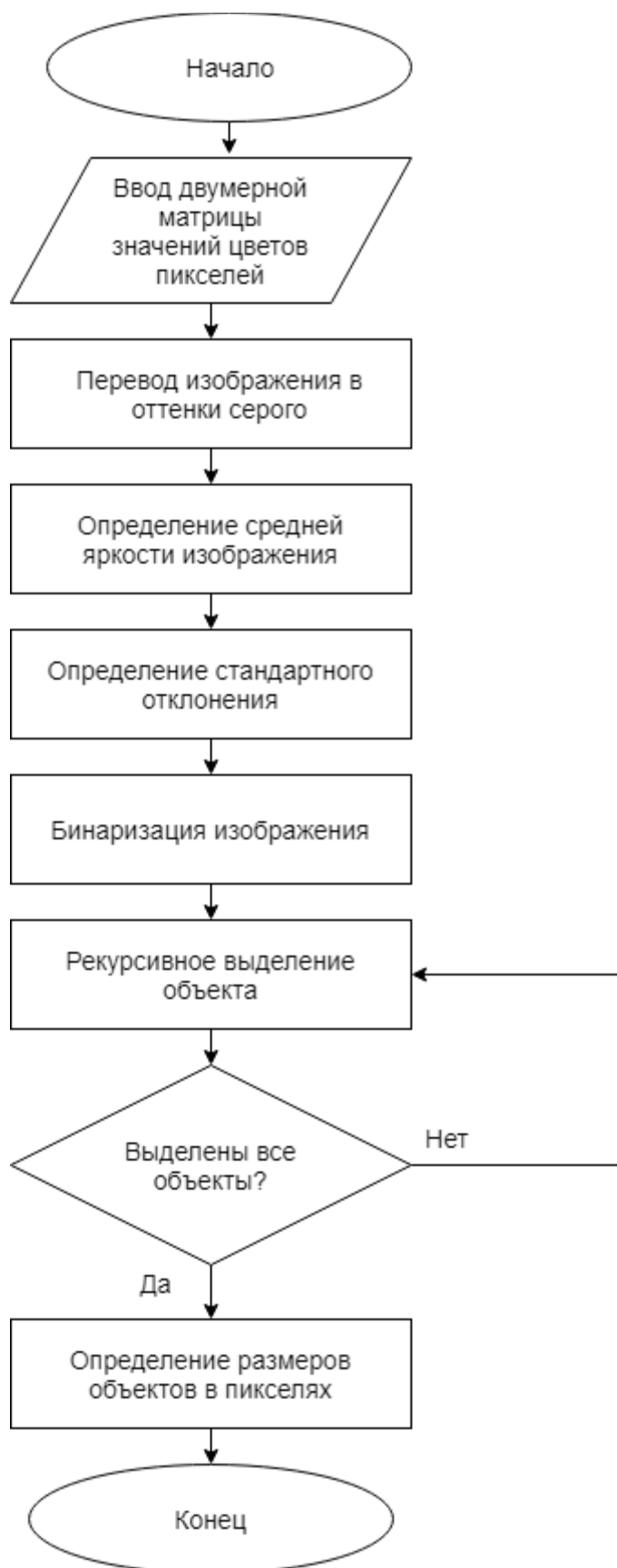
Рисунок 2.3 – Блок-схема алгоритма предобработки и получения размеров субъекта на изображении в пикселях
