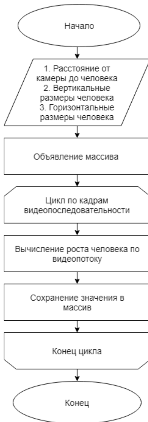
Рисунок 2.10 – Блок-схема алгоритма измерения роста человека по видеопотоку
