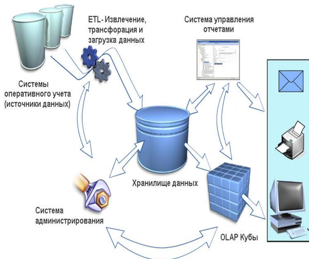
Рисунок 1.2 - Схема взаимодействия компонентов ИАС
