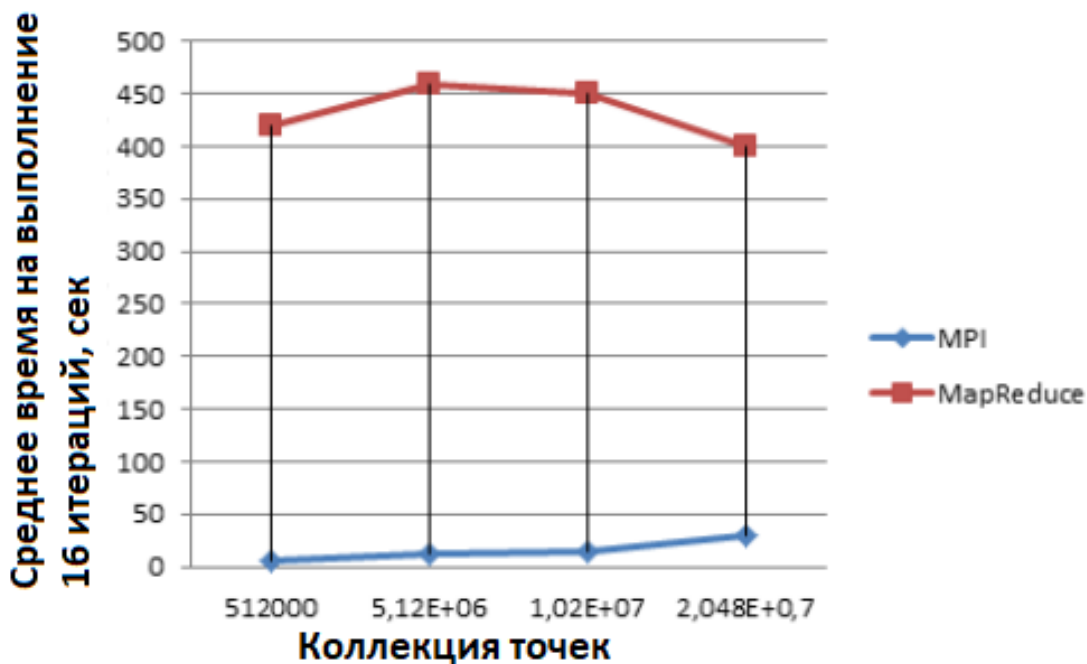
Рисунок 2.4 - Производительность в MapReduce и MPI для K-means кластерных вычислений
