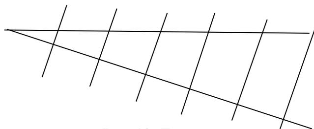
Рис. 19. Деление отрезка
