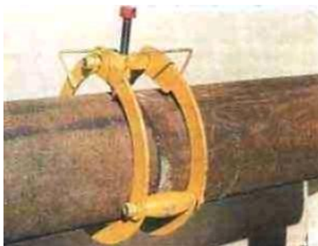
Рисунок 1.5 – Сборка труб под сварку
