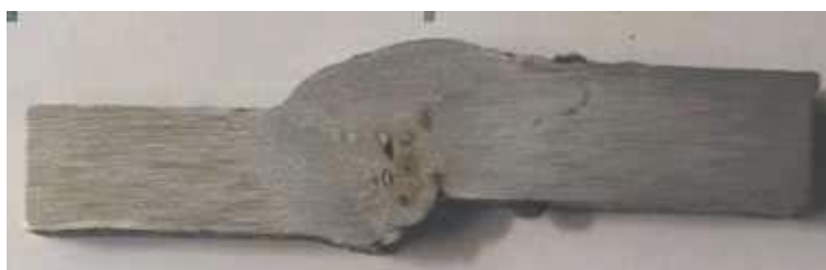
Рисунок 1.9 – Наличие пор и смещения кромок в шве
