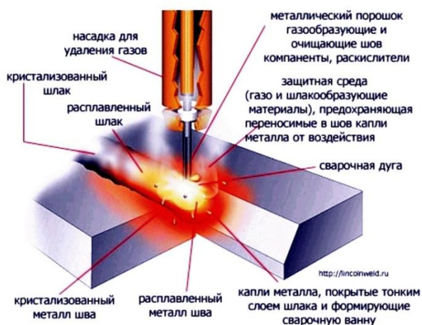
Рисунок 2.2 – Схема сварки с применением порошковой проволоки
