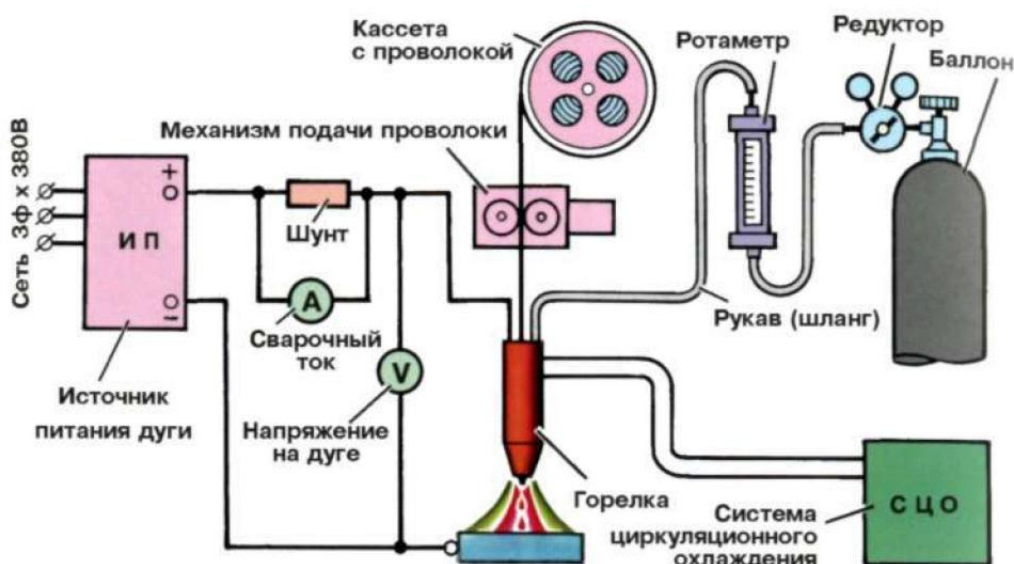
Рисунок 2.5 – Схема сварки в среде защитного газа с использованием электродной проволоки
