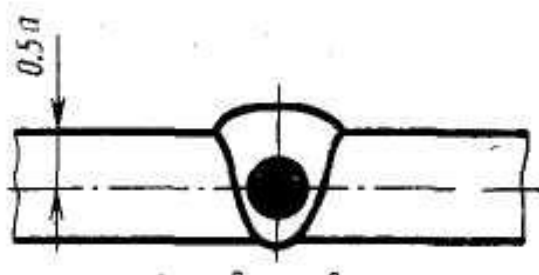
Рисунок 2.3 – Место вырезки образца согласно требований ГОСТ
