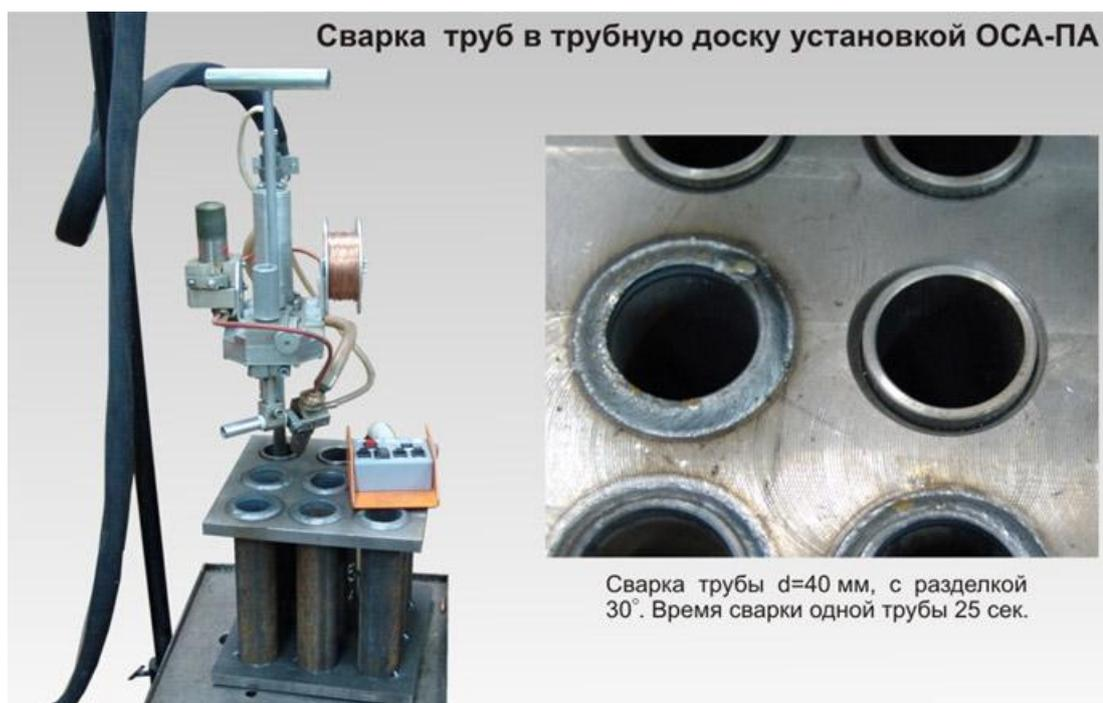
Рисунок 2.12 – Сварка труб на установке ОСА-ПА
