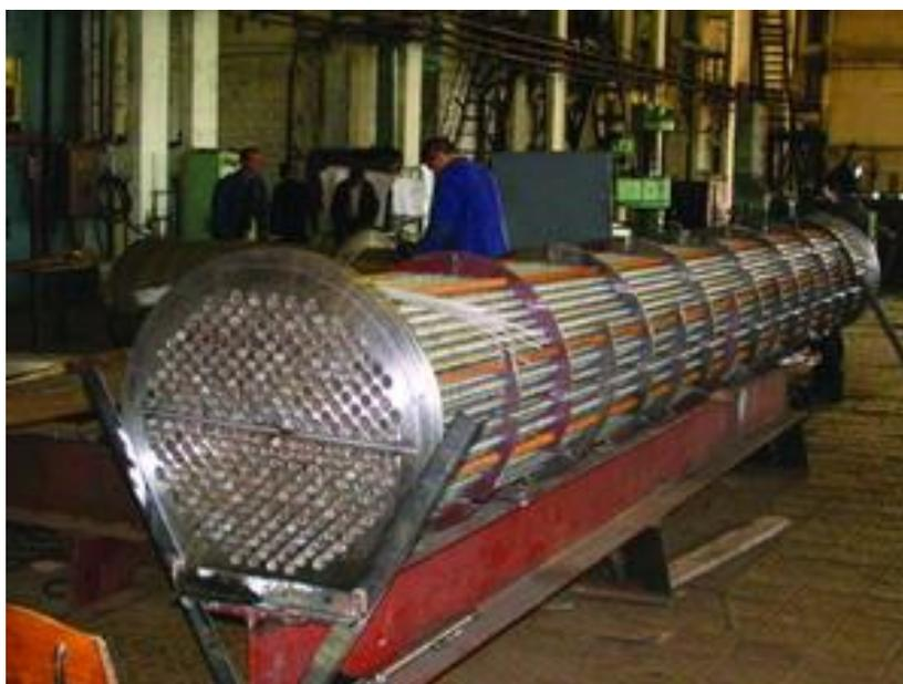
Рисунок 2.11 – Сборка труб и трубных досок
