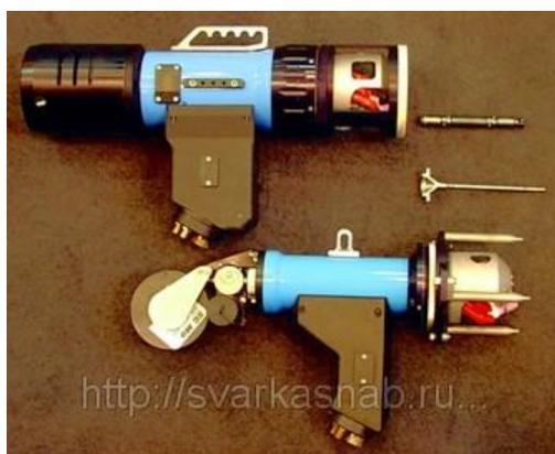
Рисунок 2.3 – Установка TIGTRONIC RBK
