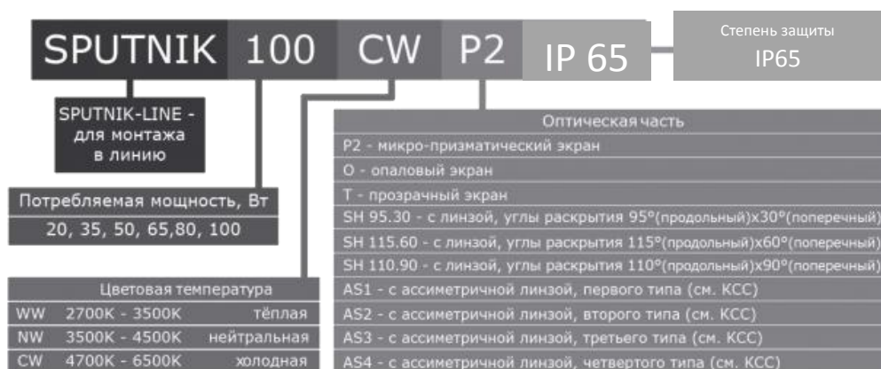
Рисунок 2.4 – Маркировка светильника SPUTNIK
