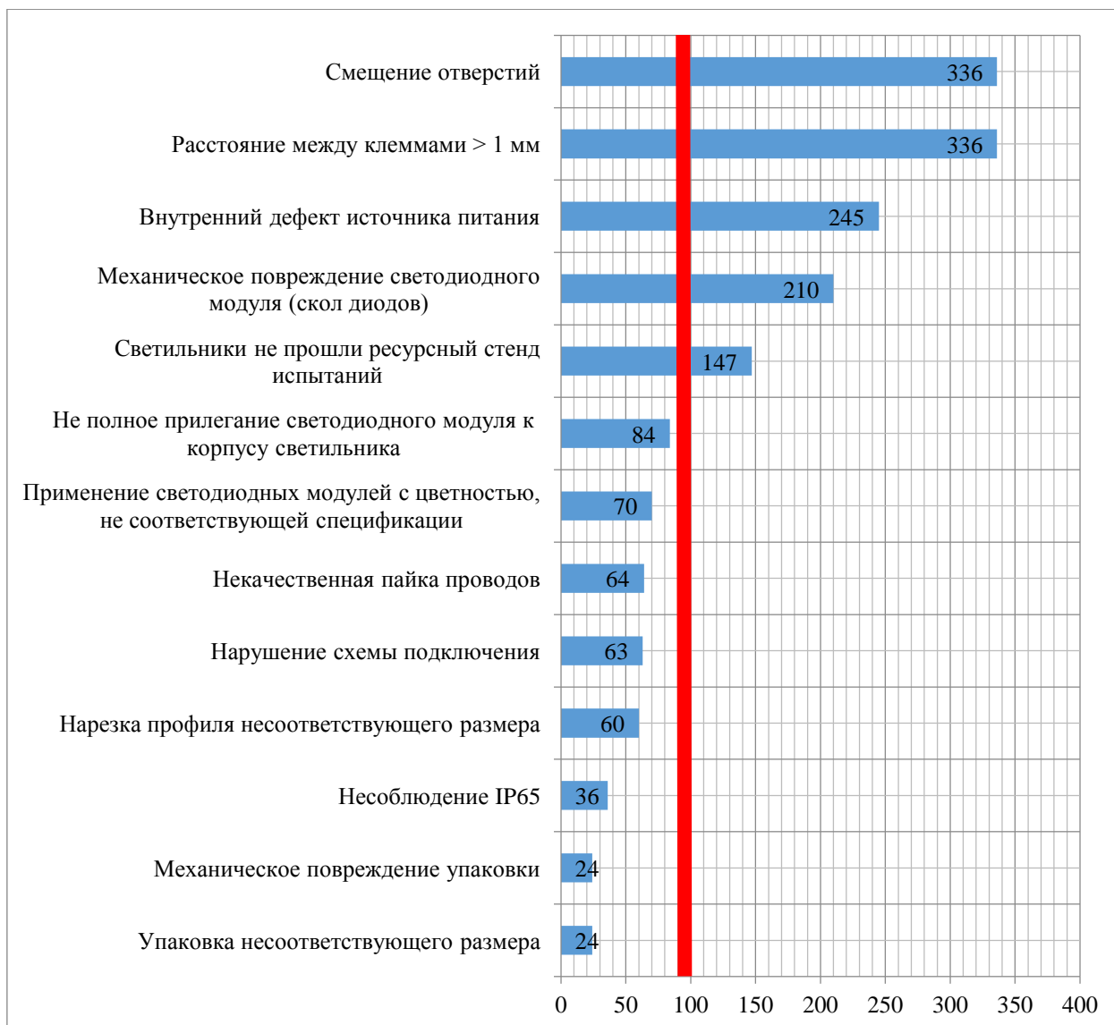
Рисунок 2.9 – Упорядоченный по убыванию ПРЧ перечень несоответствий
