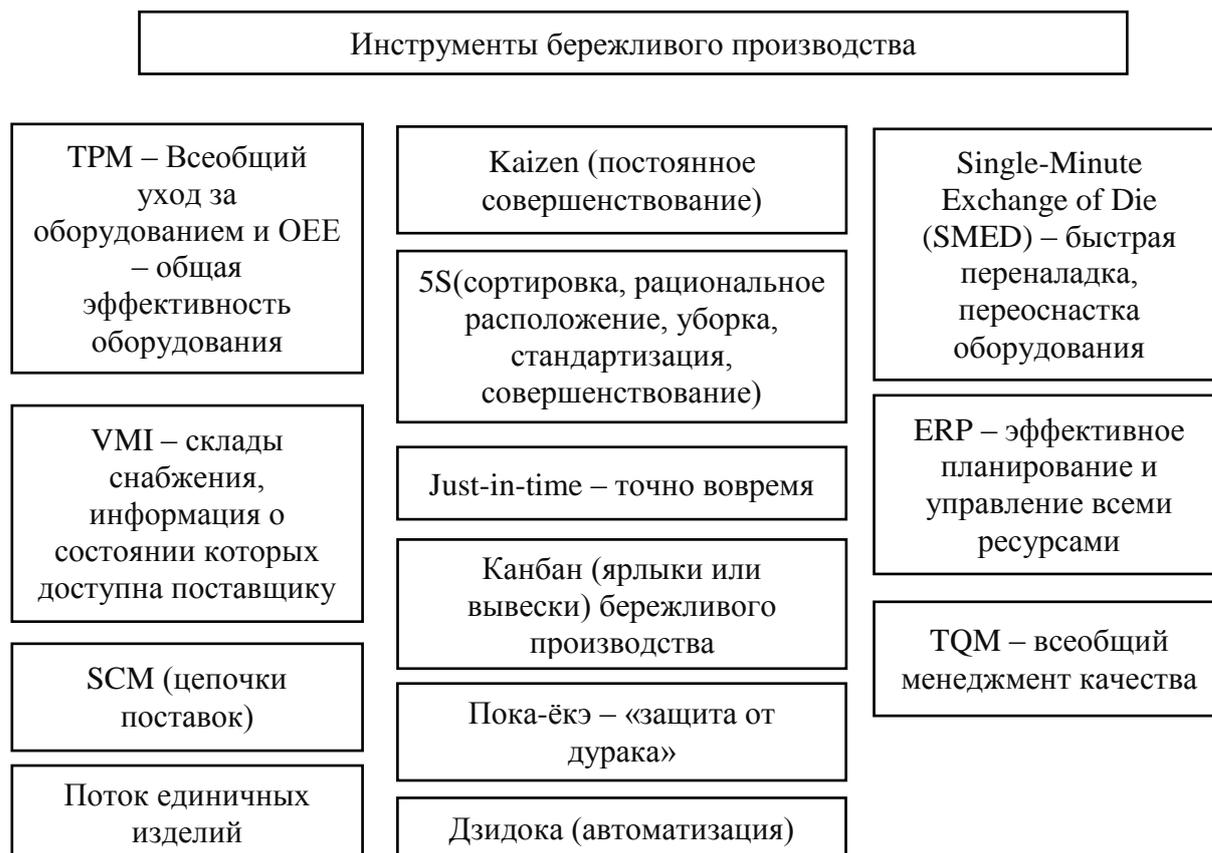
Рисунок 1.1 – Инструменты концепции Бережливого производства[22, с. 89]
