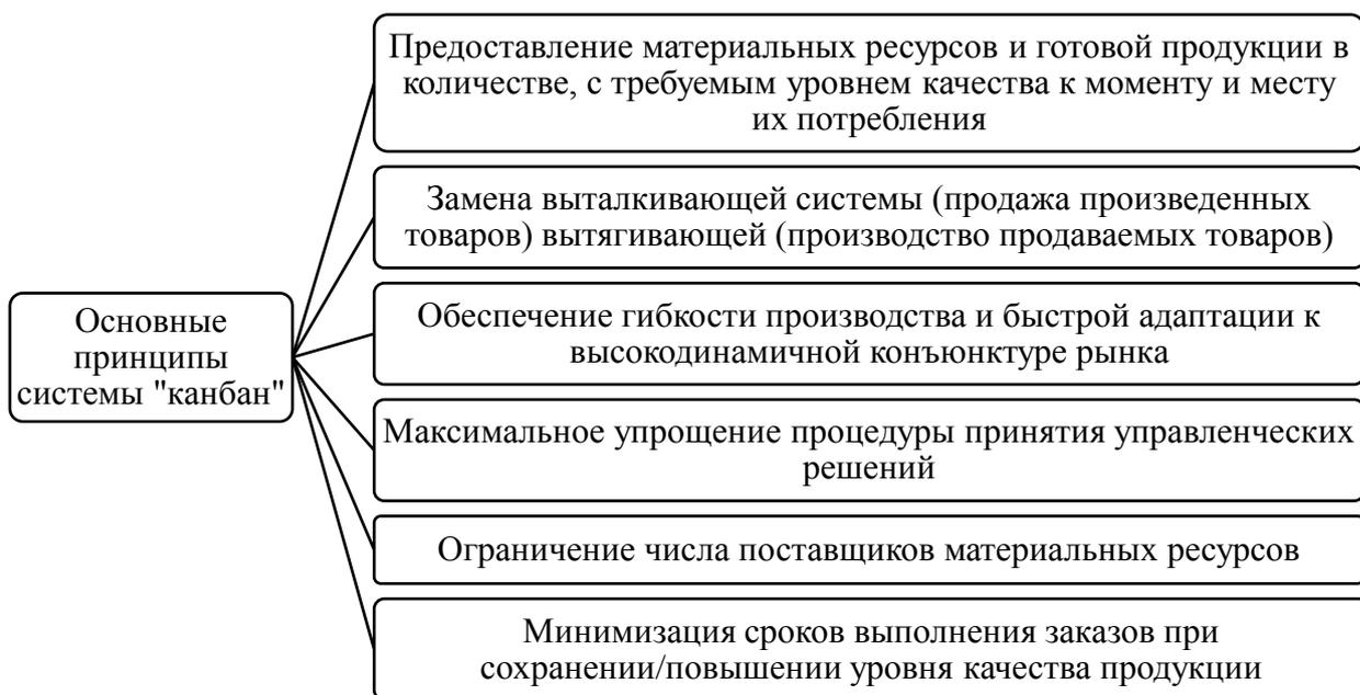
Рисунок 12 – Комплекс принципов системы «канбан»
