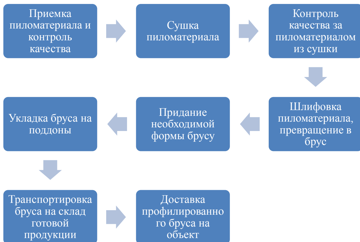
Рисунок 3.2 - Производственный процесс ООО «Фитедо» после предложенных мероприятий.
