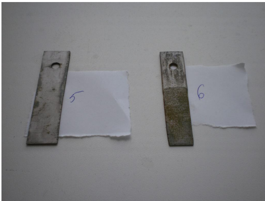
Рисунок 23 – Пластины после воздействия кислоты при температуре 85°C. Слева с ингибитором, справа – без обработки ингибитором.
