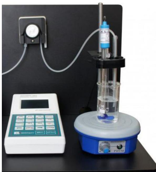
Рисунок 11 – Установка для измерения электродного потенциала
