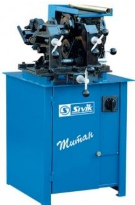
Рисунок 2.3 – Стенд для правки дисков Sivik TITAN ST-16
