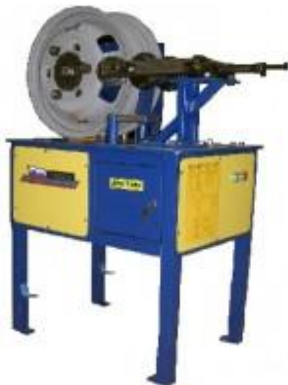
Рисунок 2.2 – Стенд для правки дисков ГАРО ДПС-3МУ
