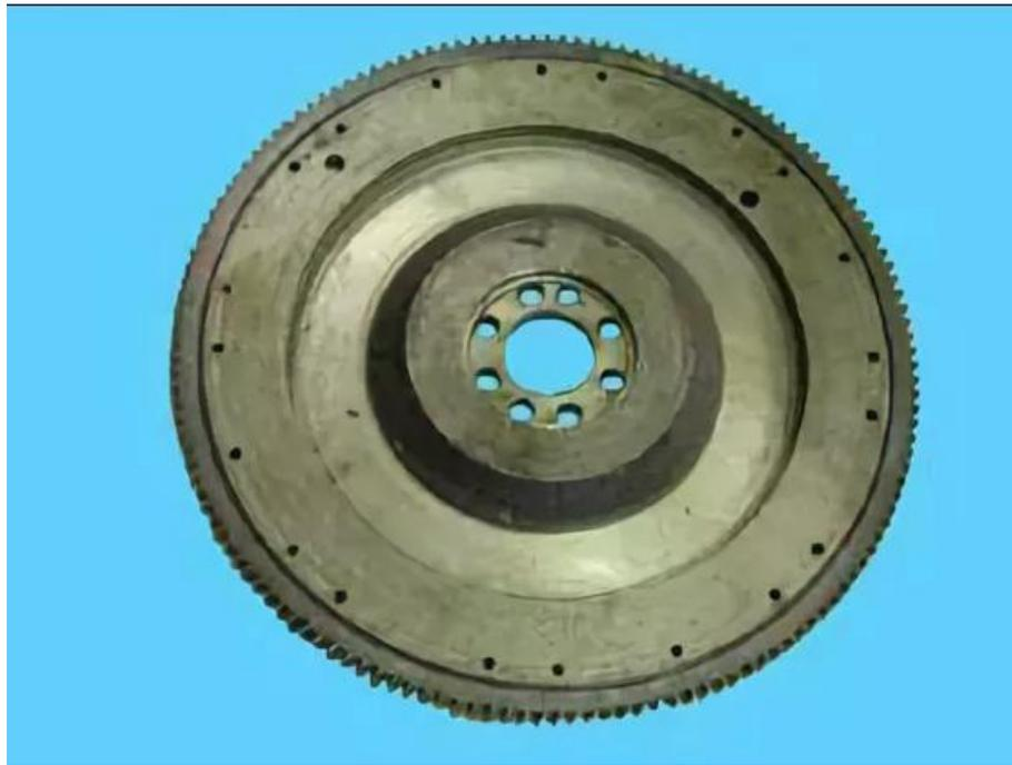
Рисунок 3.3 – Маховик от автомобиля ЗИЛ-5301 «Бычок»
