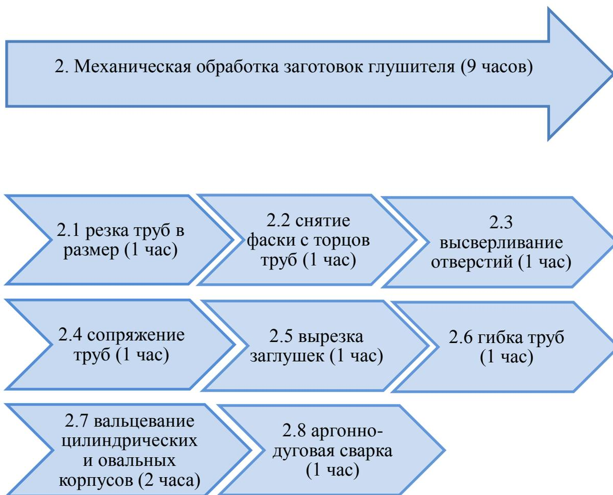
Рисунок 2.8 – Процесс механической обработки заготовок для глушителя ООО «ТД «Тольятти-Глушители»
