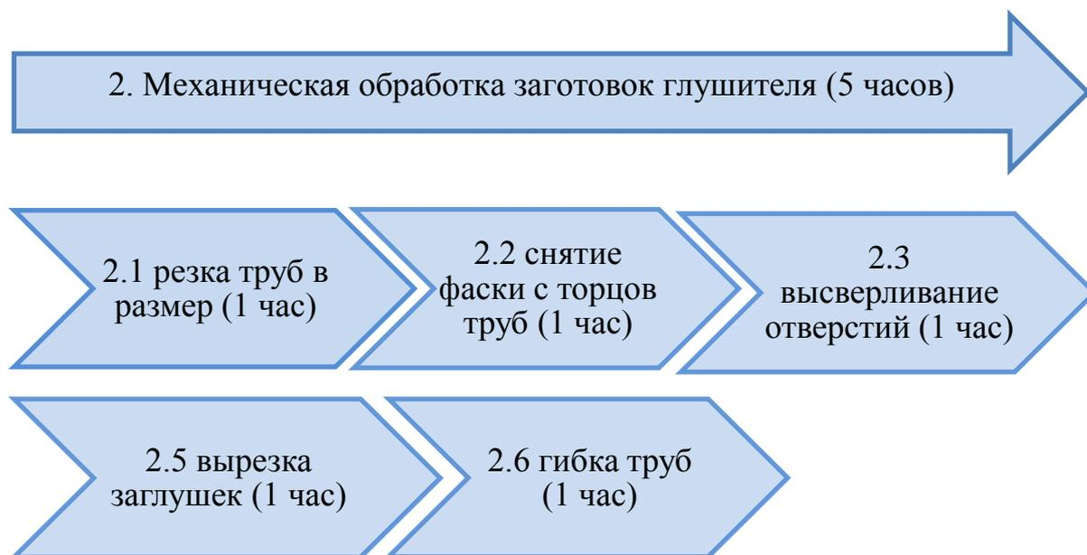
Рисунок 2.12 – Процесс обработки заготовок для глушителя по закатной технологии производства для ООО «ТД «Тольятти-Глушители»
