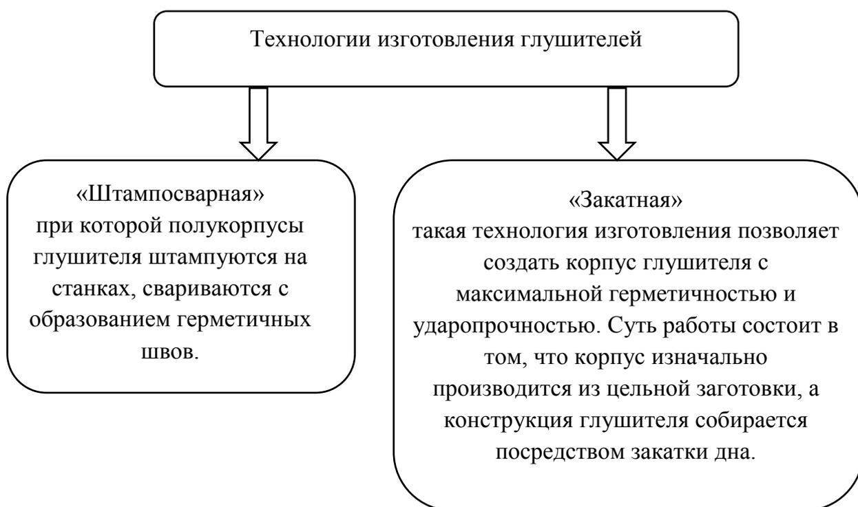
Рисунок 2.4 – Технологии изготовления глушителей
