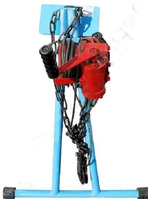
Рисунок 1.2 – Приспособление П-240 для снятия и установки КПП
