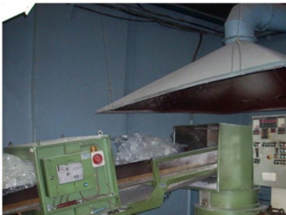
Рисунок 4.1 –Автоматизированная линия по переработке отходов полимеров в гранулят
