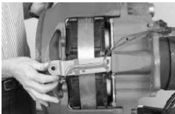
Рис. 3.6 Установить плиту держателя колодки.
