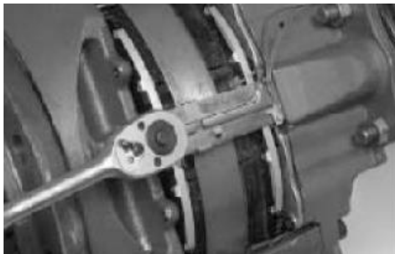
Рис. 3.2 Вывинтить болт плиты держателя колодки
