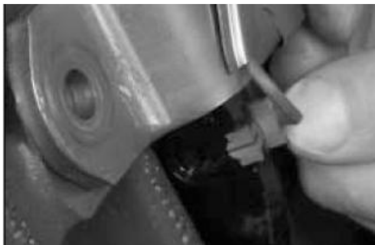
Рис. 3.8 Установить датчики износа колодок
