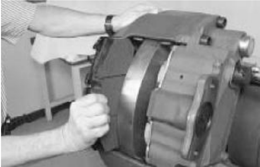
Рис. 3.4 Демонтаж тормозной колодки
