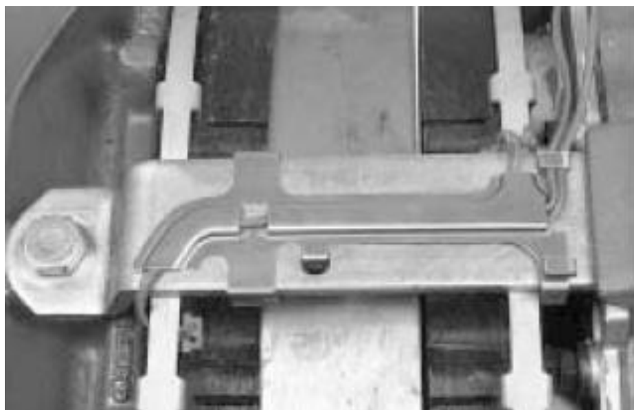
Рис. 3.9 Установить держатель тормозной колодки
