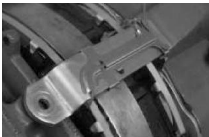
Рис.3.7 Установить пружины-фиксаторы колодок
