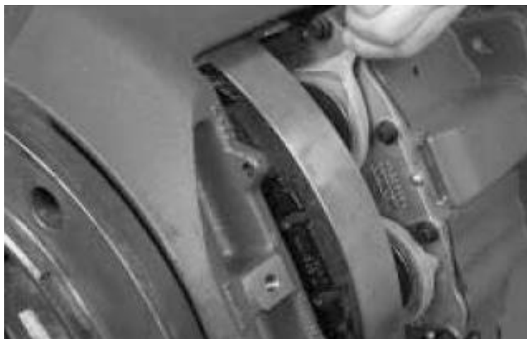
Рис. 3.5 Свести поршень тормозного цилиндра
