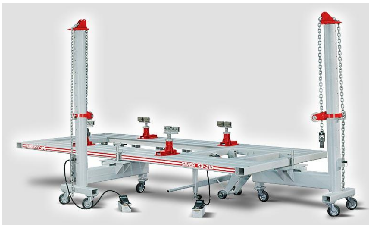
Рисунок 2.2 - Стенд правки кузова СИВЕР С3-210
