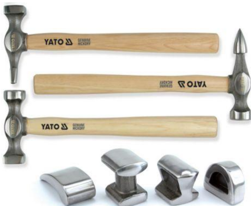
Рисунок 3.2 – Рихтовочные молотки и выколотки
