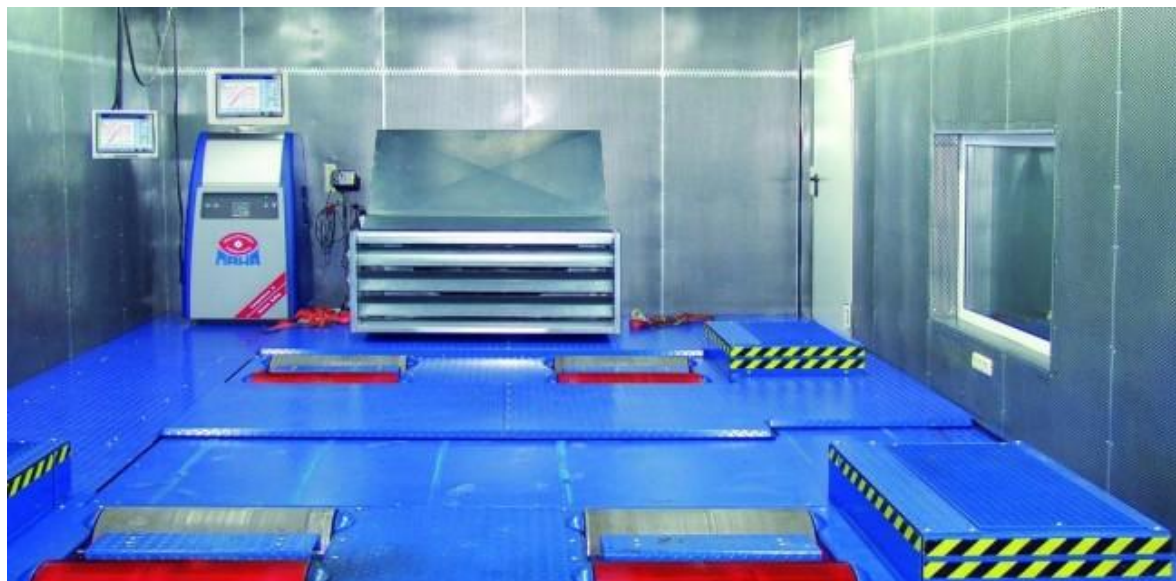
Рисунок 2.2 – Стенд тяговых качеств МАНА LPS 3000
