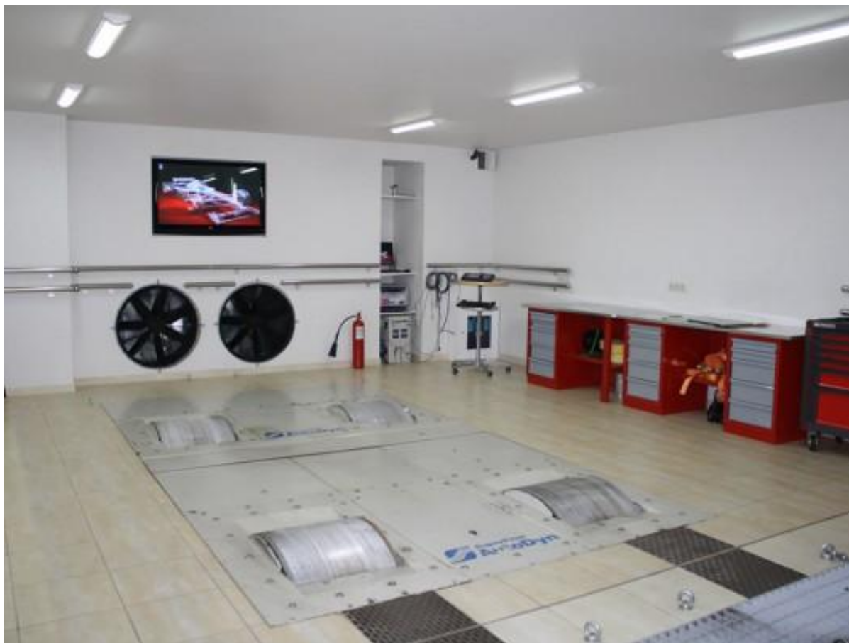
Рисунок 2.3 – Стенд тяговых качеств Superflow 880AWD
