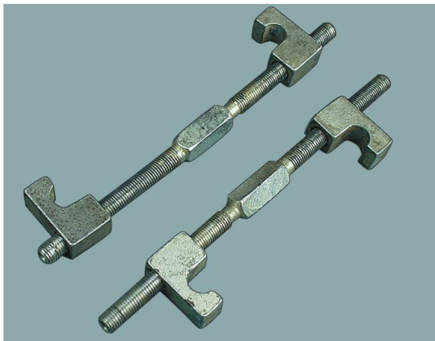
Рисунок 2.1 - Устройство для стяжки пружин, разработанное по рекомендации ОАО «АвтоВАЗ»
