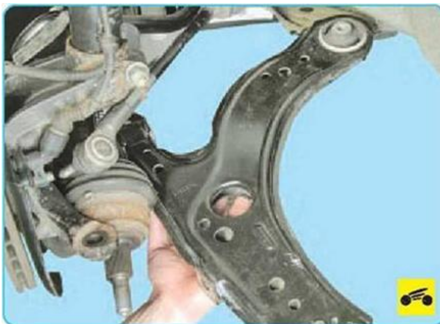
. Рисунок 3.3 – Демонтаж рычага при проведении ремонтных работ
