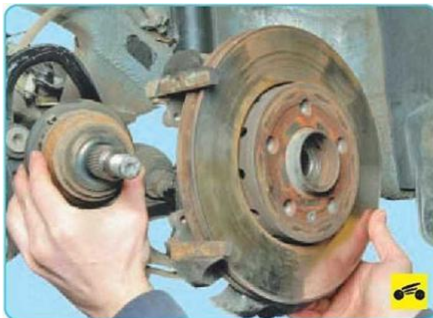
Рисунок 3.2 – Демонтаж ШРУСа при проведении ремонтных работ
