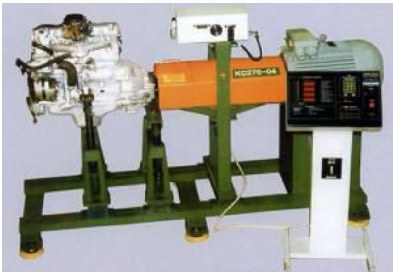
Рисунок 2.2 - Стенд КС 276-04, стенд универсальный обкаточный
