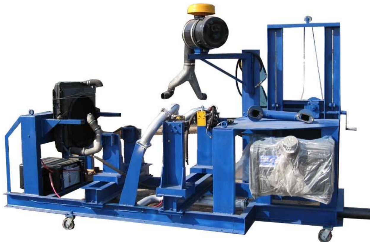
Рисунок 2.1 - СОД.1001.0000.000 Стенд горячей обкатки двигателей
