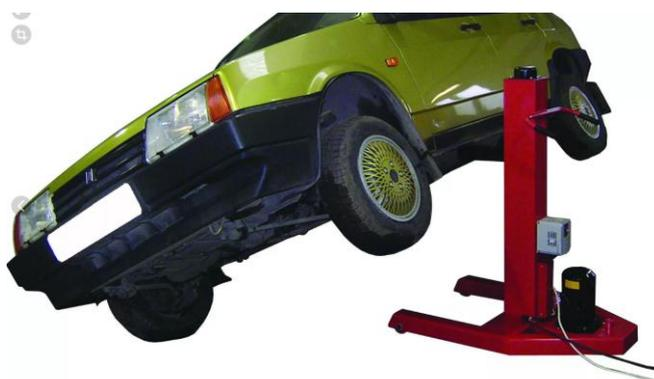
Рисунок 2.3 – Подъемник опрокидыватель ПП-1
