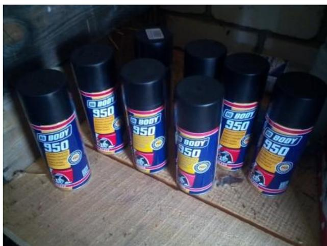
Рисунок 3.2 – Аэрозольные баллоны с антикоррозионным материалом
