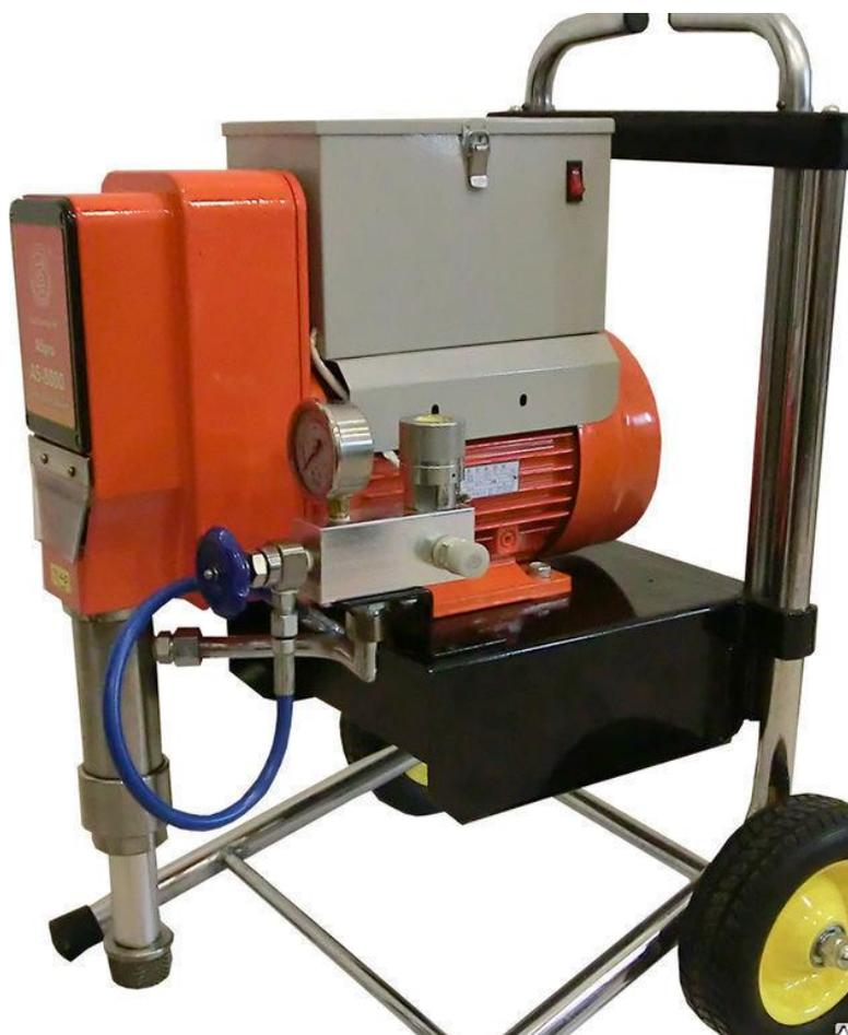
Рисунок 2.3 – Аппарат безвоздушного распыления мастики ASPRO-8000
