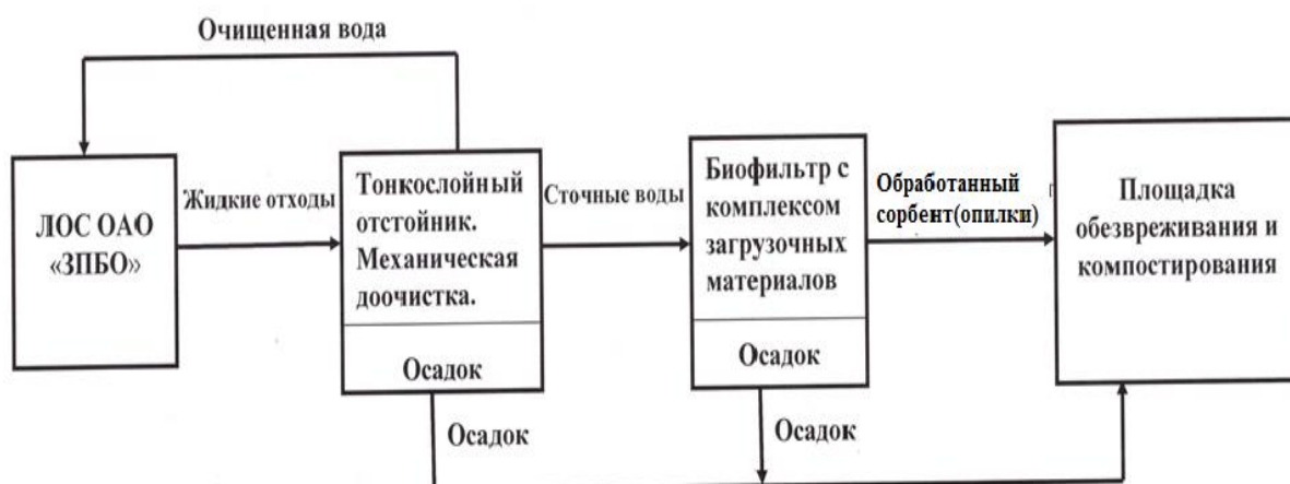
Рисунок 5- Предлагаемая схема обезвреживания и переработки жидких отходов ОАО «ЗПБО»
