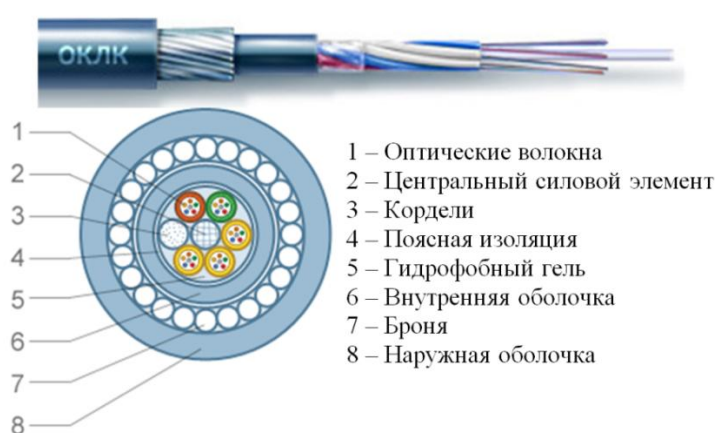
Рисунок 3.11 – Внешний вид оптического кабеля типа ОКЛК
