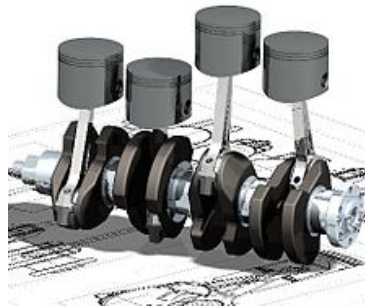
Une vue oblique des pistons et du vilebrequin d'un quatre cylindres en ligne
