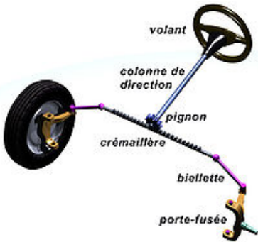
Schéma d'une direction à crémaillère
