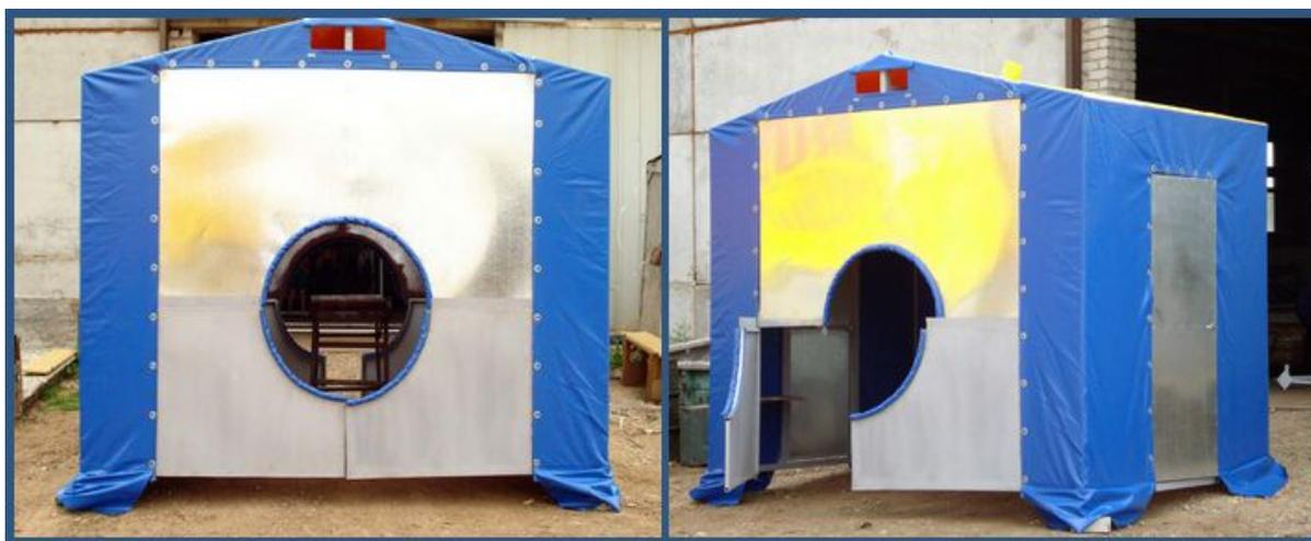
Рисунок 4.1- Общий вид быстро разборной-сборной палатки сварщика для сварки трубопроводов
