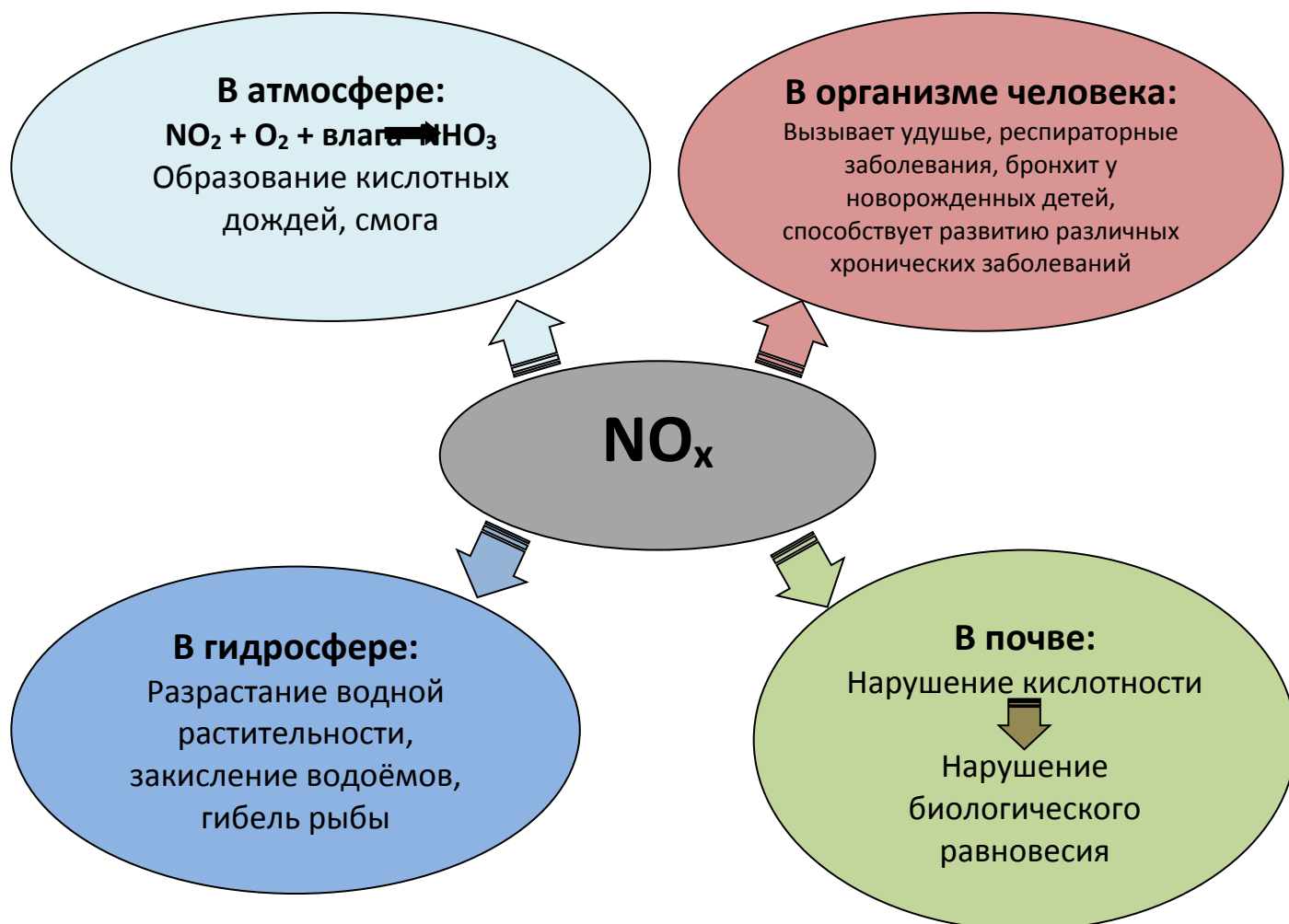
Рисунок 2 – Схема воздействия оксидов азота на окружающую среду и организм человека
