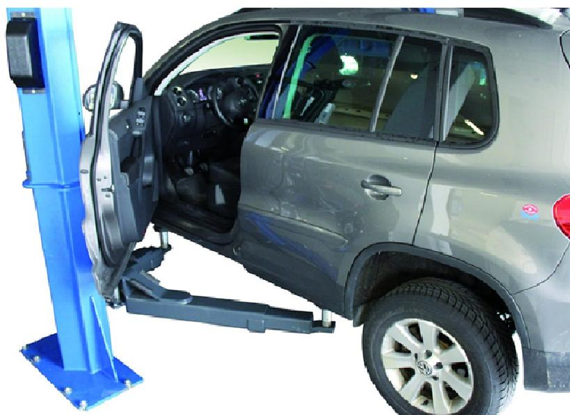
Рисунок 4.2 – Открытие передних дверей при установке автомобиля на двухстоечном подъёмнике
