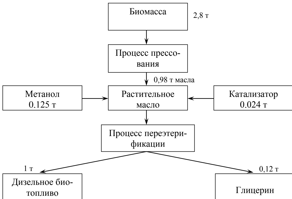
Рисунок 16 - Принципиальная схема производства дизельного биотоплива
