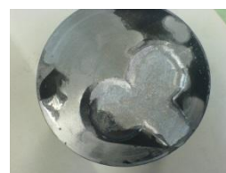
Фрезерование рабочей поверхности поршня
