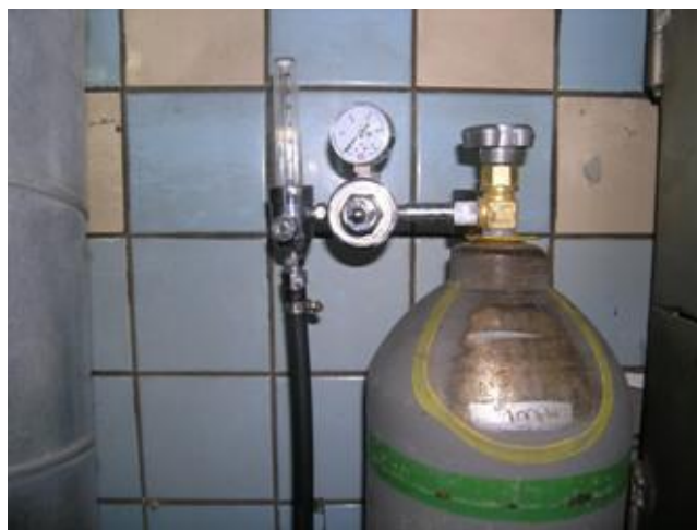
Рисунок 1.3 – Баллон для аргона с поплавковым ротаметром и редуктором
