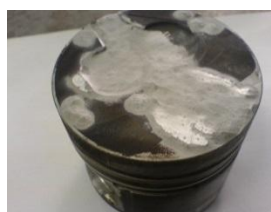
Наплавка рабочей поверхности поршня
