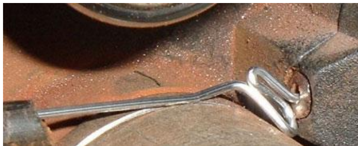
Рисунок 1.9 – Смятие алюминиевой проволоки в механизме подачи
