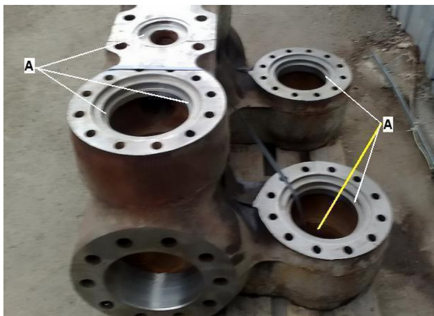
Рисунок 1.2 – Места промоин на корпусе насоса
