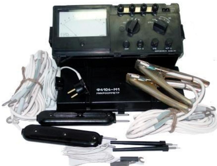
Рисунок 2.1 – Внешний вид микроомметра Ф4104-М1
