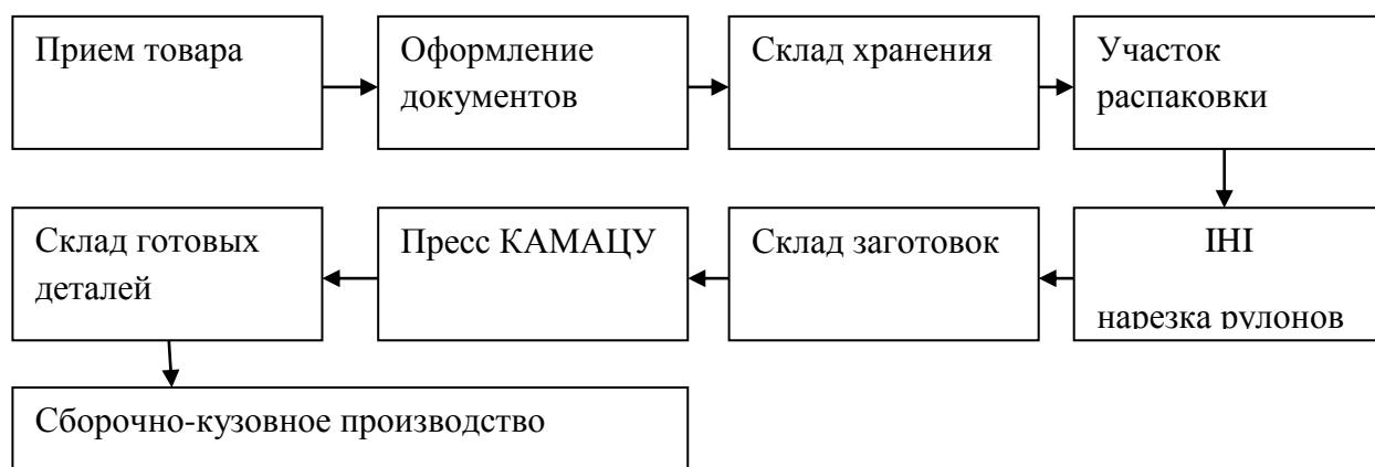
Рисунок 2.5 – Схема транспортировки продукции в ПрП
