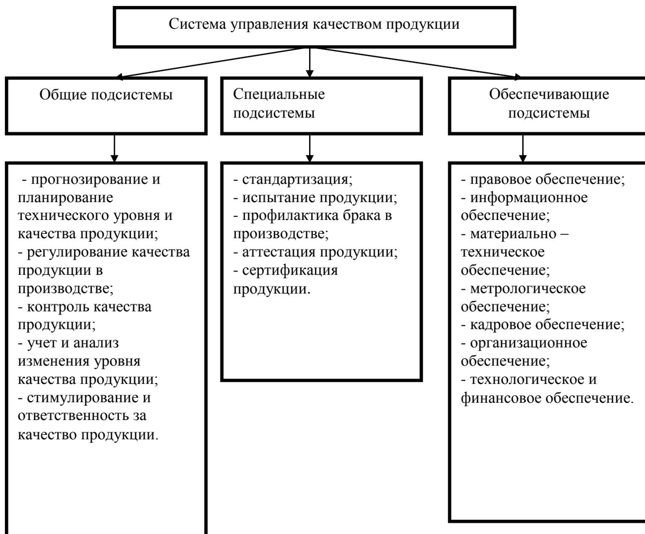
Рисунок 1.2 – Система управления качеством продукции на предприятии
