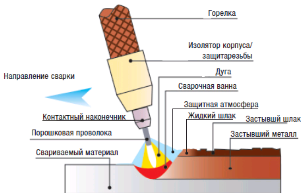
Рисунок 2.4 – Сварка порошковой проволокой
