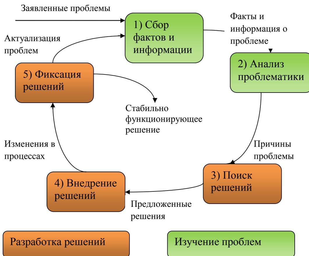
Рисунок 1– Общий подход к оптимизации производства
