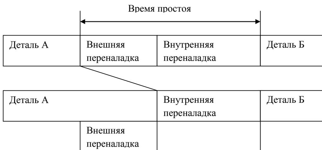
Рисунок 11 – Схема разделения переналадок
