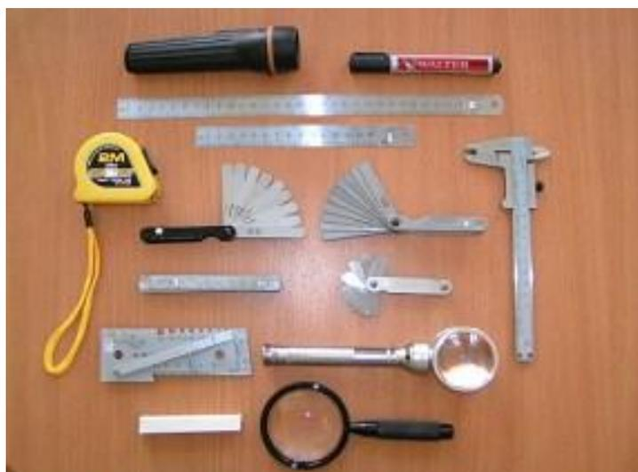
Рис.17- Набор инструментов для визуального метода контроля
