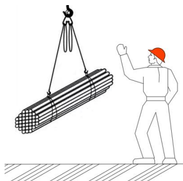
Рисунок 3.1 – Строповка арматурных стержней
