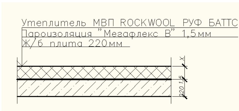
Рисунок 1.2 - Схема чердачного перекрытия
