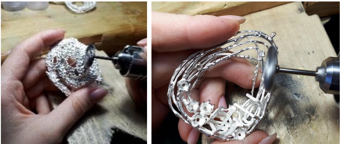
Рисунок 2. Общие технологические операции. Процесс обработки металла крацовкой.
