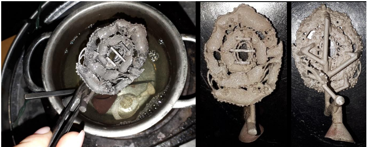
Рисунок 10. Литье по выплавляемым моделям. Отбеливание деталей в лимонной кислоте.
