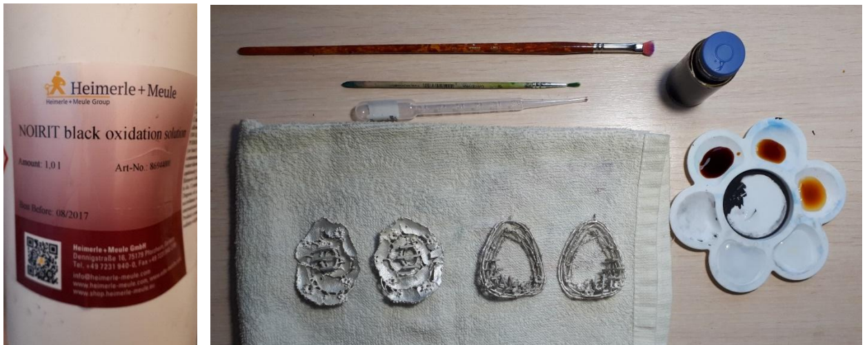
Рисунок 4. Общие технологические операции. Процесс оксидирования. Рабочее место.
