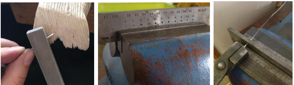
Рисунок 7. Изготовление серёг «Пробуждение». Монтировка. Изготовление проволоки. Заостряем кончик проволоки для дальнейшего ее волочения. Процесс волочения проволоки.
