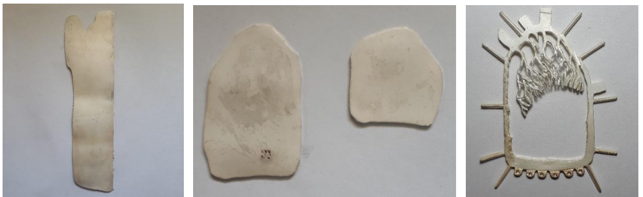
Рисунок 2. Изготовление серёг «Пробуждение». Монтировка. Полученный слиток раскатываем в вальцах. Выпиловка из пластины заготовок.
