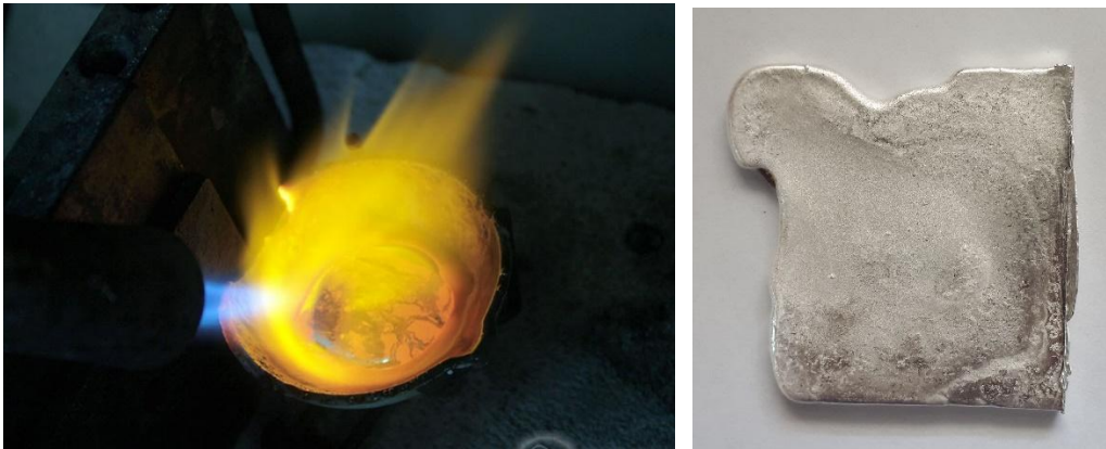
Рисунок 1. Изготовление серёг «Пробуждение». Монтировка. Плавка металла.
