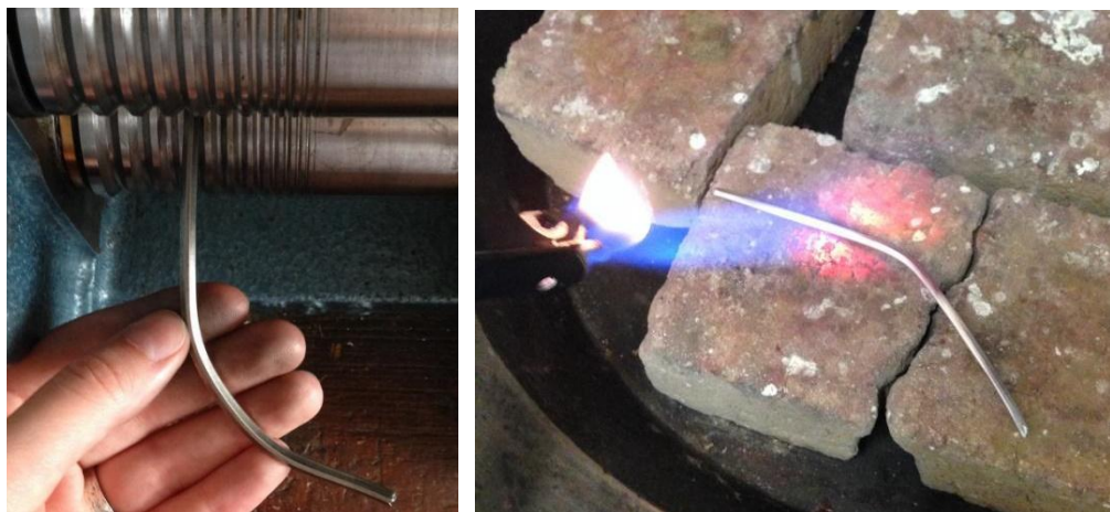
Рисунок 6. Изготовление серёг «Пробуждение». Монтировка. Изготовление проволоки. Прокатка в вальцах и обжиг.
