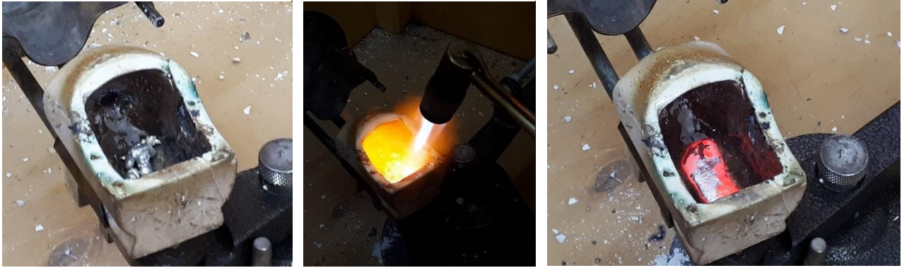
Рисунок 8. Литье по выплавляемым моделям. Центробежная литейка. Плавка сплава.
