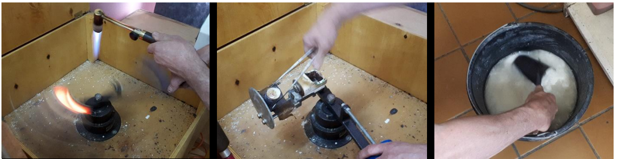
Рисунок 9. Литье по выплавляемым моделям. Процесс литья, проливка металла. Снятие опоки с литейной установки. Промывание опоки и модельного блока.
