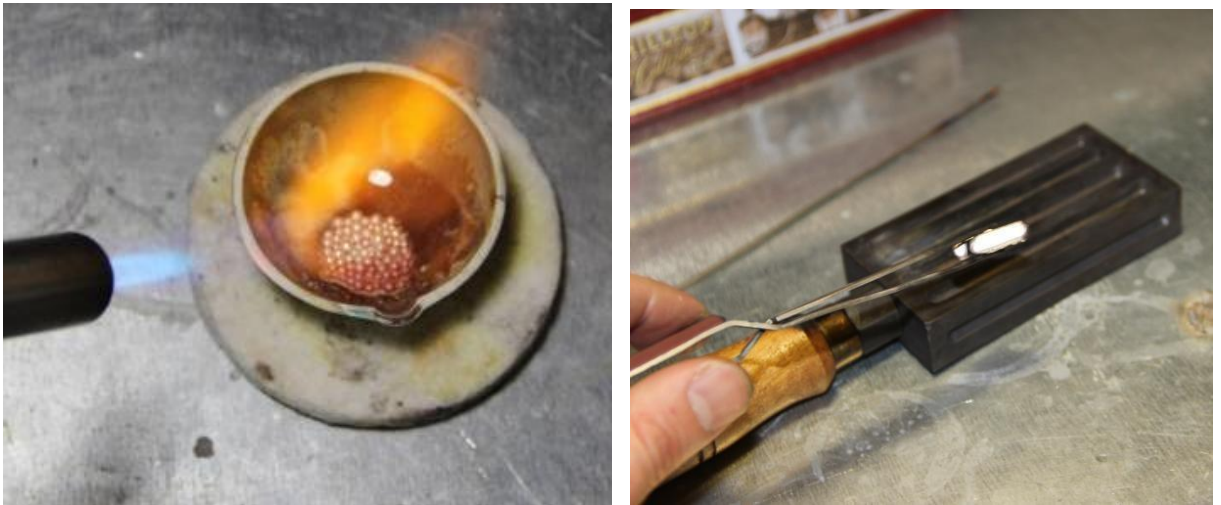
Рисунок 5. Изготовление серёг «Пробуждение». Монтировка. Изготовление проволоки. Плавка металла и заливка в изложницы.
