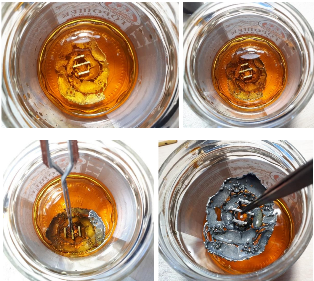
Рисунок 5. Общие технологические операции. Процесс оксидирования.
