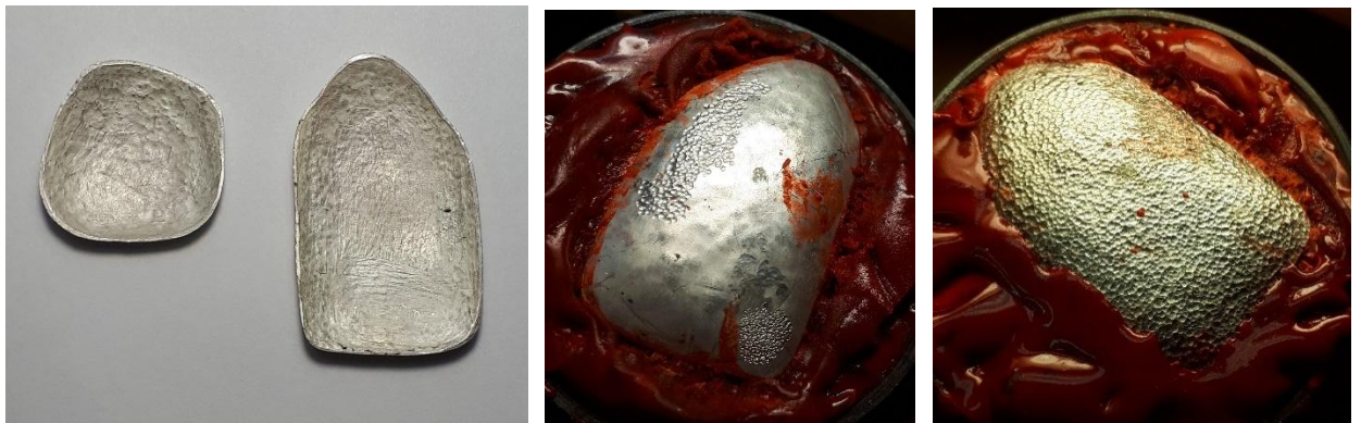
Рисунок 4. Изготовление серёг «Пробуждение». Монтировка. Выколотка.
