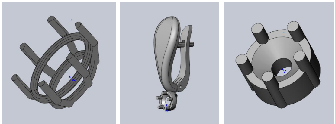
Рисунок 5. 3D-моделирование. Каст для камня в форме овала. Швенза. Каст для камня в форме круга.
