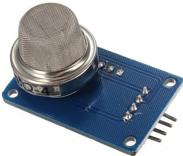
Рисунок 8 - Датчик газа MQ-4(бутан, пропан, метан, дым).
