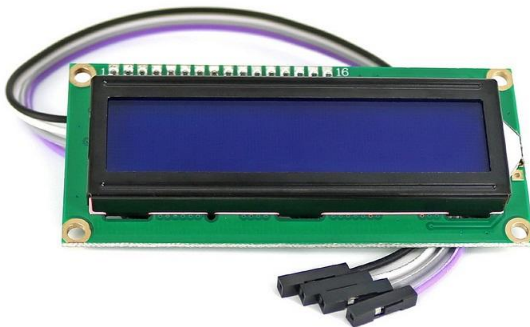
Рисунок 15 – Внешний вид сверху текстового дисплея LCD1602 с преобразователем I2C интерфейса.
