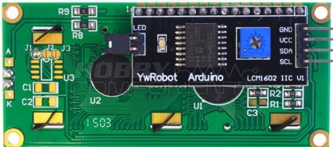
Рисунок 16 – Внешний вид снизу текстового дисплея LCD1602 с преобразователем I2C интерфейса.
