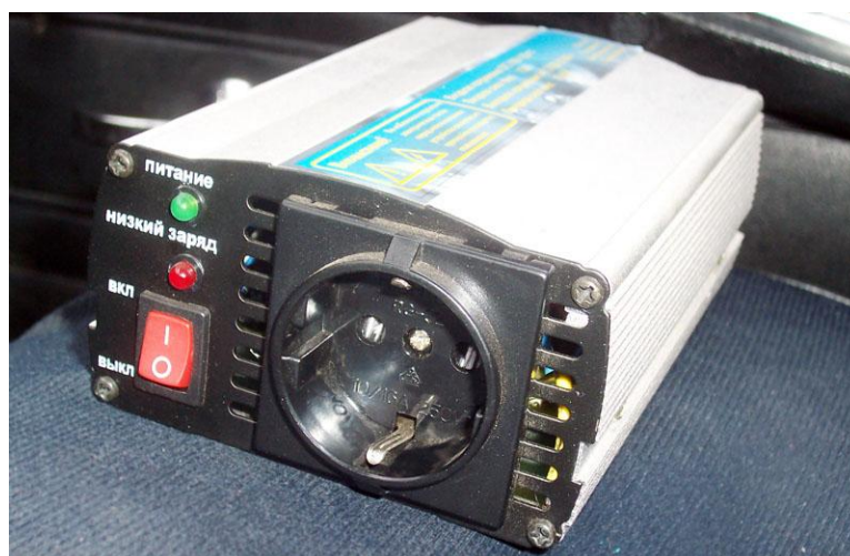
Рисунок 6 – Инвертор, работающий от автомобильной бортовой сети 12 В и предназначенный для питания устройств переменным напряжением 220 В.
